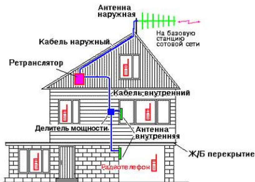
Рисунок 1. Пример системы с ретранслятором PicoCell 900 SXA .
